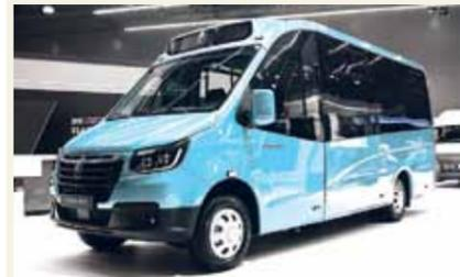
Среди них лёгкий коммерческий автомобиль нового поколения «ГАЗель NN». Он отличается наличием интеллектуальной платформы, обеспечивающей высокий уровень безопасности, низкую утомляемость водителя и экономическую эффективность работы, оборудован камерами, радарными и ультразвуковыми датчиками, которые следят за ситуацией на дороге и вокруг автомобиля.
