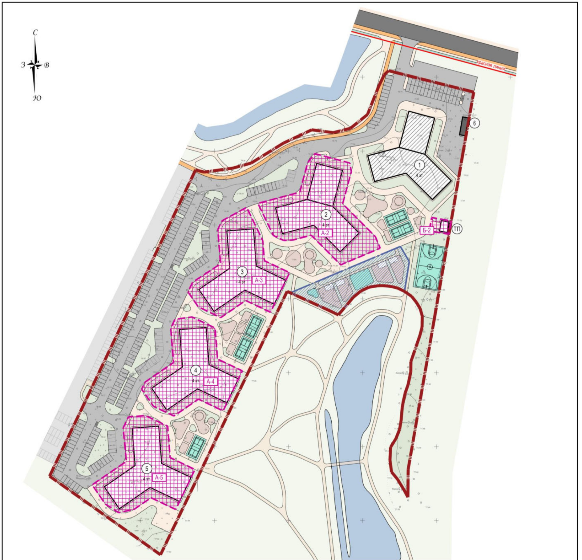
Экспликация зон планируемого размещения объектов капитального строительства
